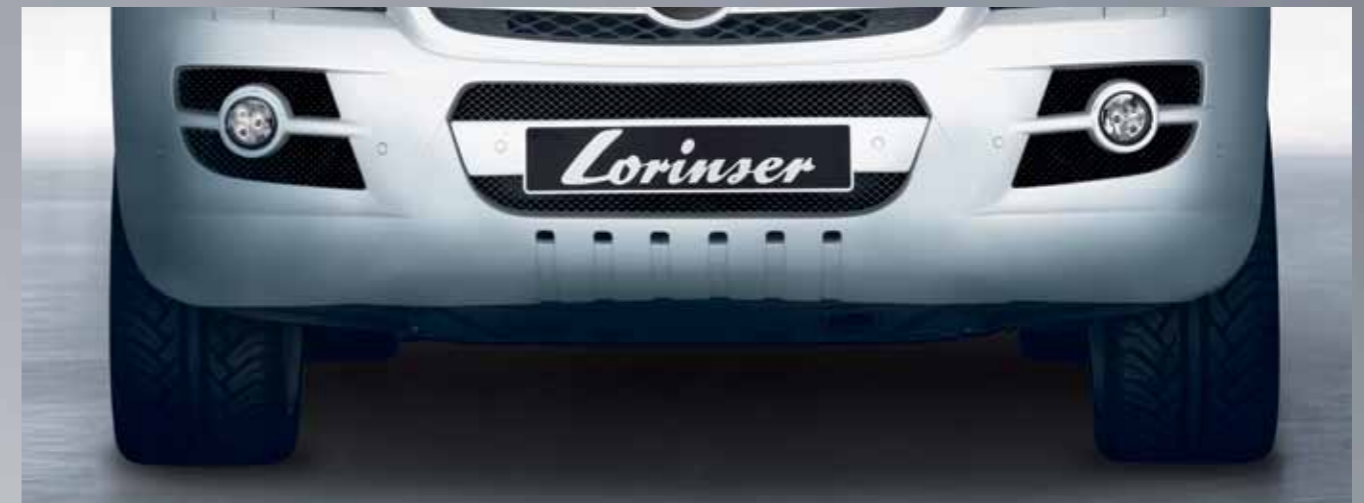
Dominanter Spoilerstoßfänger mit integrierten Zusatzscheinwerfern Striking spoiler bumper with built-in additional headlights
